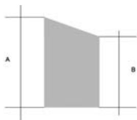
El descuadre de los lados largos de esta pieza sería A - B . Nota: en todas las figuras de ejemplo, el defecto se ve exagerado para poder definirlo mejor.
